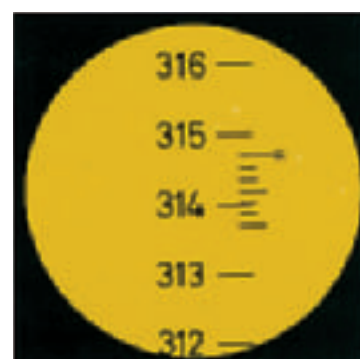
Lectura del círculo horizontal con el NAK2: (360°) 314°42'
